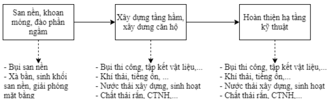
Hình 1. 13: Sơ đồ biện pháp thi công của dự án
